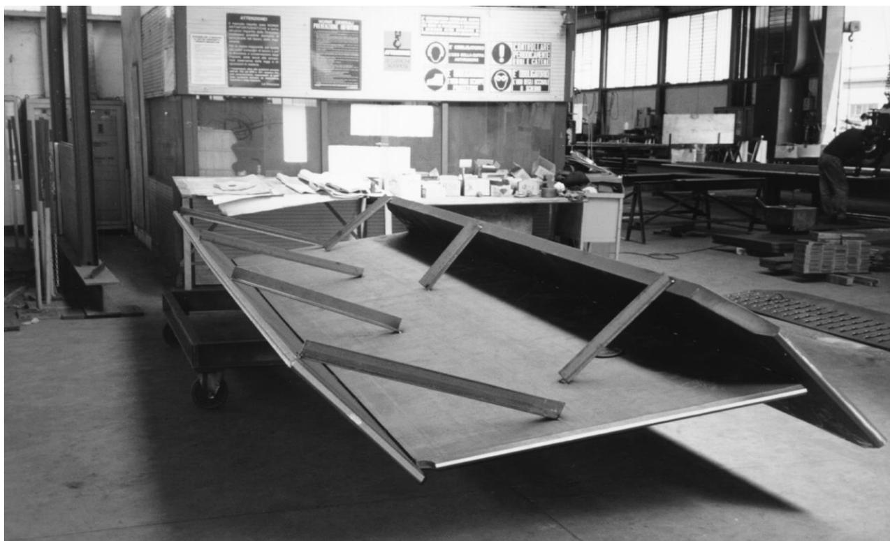
Fig. 6 – Particolare assemblaggio lamiera
