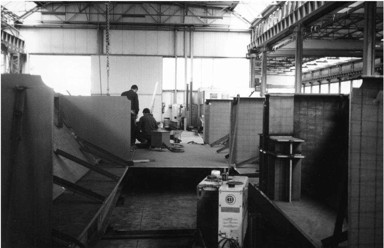
Fig. 10 – Assemblaggio di prova delle tre parti costituenti il cassone metallico
